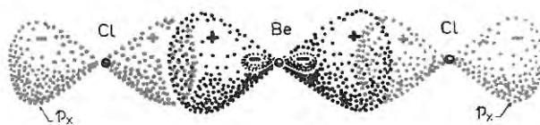
Obr. 4.12. Vznik väzieb v molekule BeCl_2
