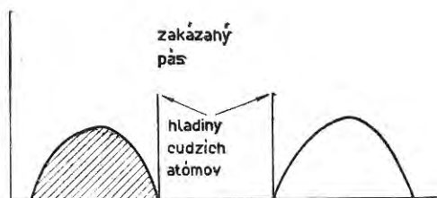
Obr. 19.6. Vznik zakázaného pásu v polovodičoch
