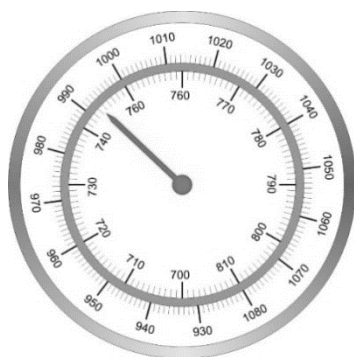
Obr. 5.15 Barometer – na vonkajšej stupnici je tlak v hPa a na vnútornej stupnici v mmHg
