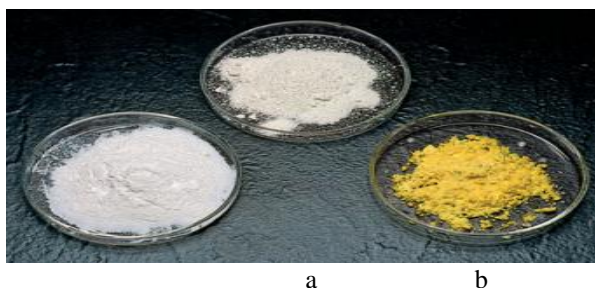
Obr. 4.8 Produkty reakcie alkalických kovov s kyslíkom a) Li_2O , b) Na_2O_2 a c) KO_2 .
